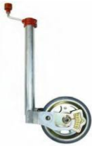
ALKO NEUSWIEL PREMIUM MET DISSELWEGER Alko 1221695 Met vorkvering en gelagerde slinger voor gemakkelijk manoeuvreren en verstellen. meet vermogen : 50 - 200 kg Buis : \phi 48 mm; wielmaat 230 x 80 mm (geboid) Gewicht : \pm 9,8 kg
